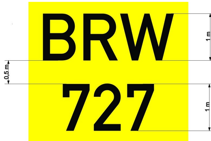
Abbildung 2: Geometrie der Beschriftung (beispielhaft in schwarzer Schrift auf gelbem Hintergrund)
