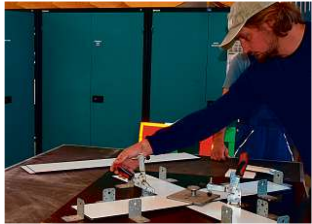
Herstellen eines Lattenrahmens
