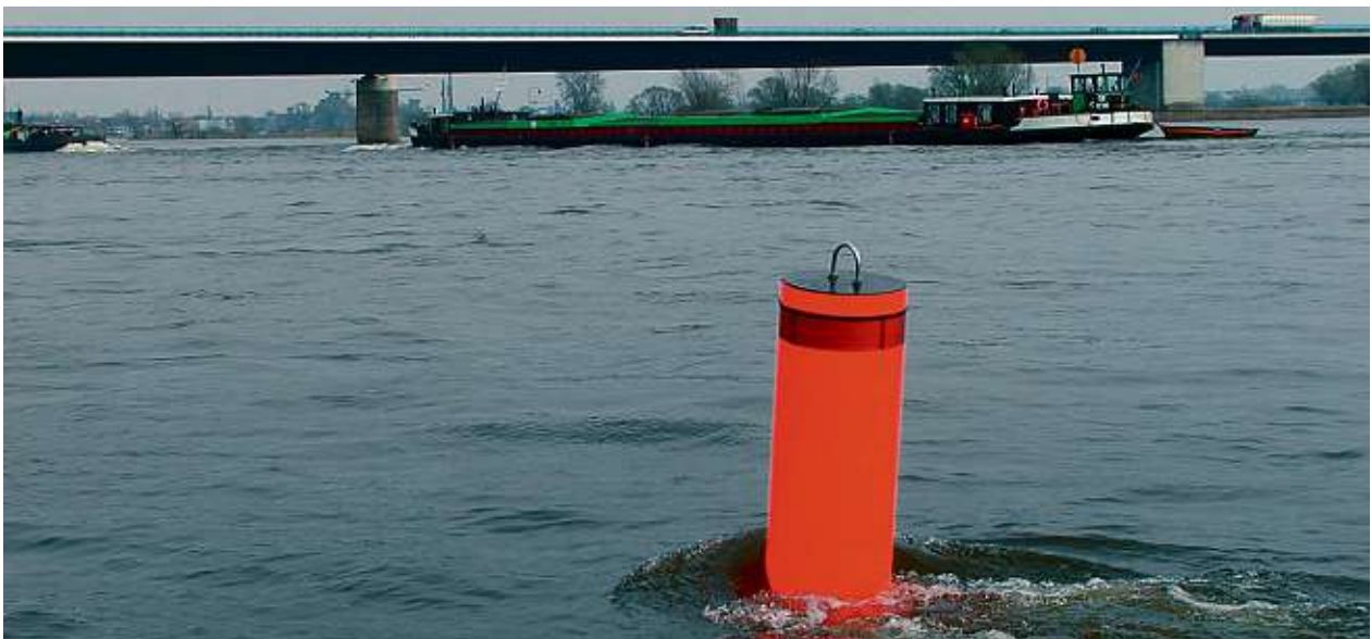
Schwimmstange mit Reflexionsfolie zur Fahrinnenkennzeichnung
