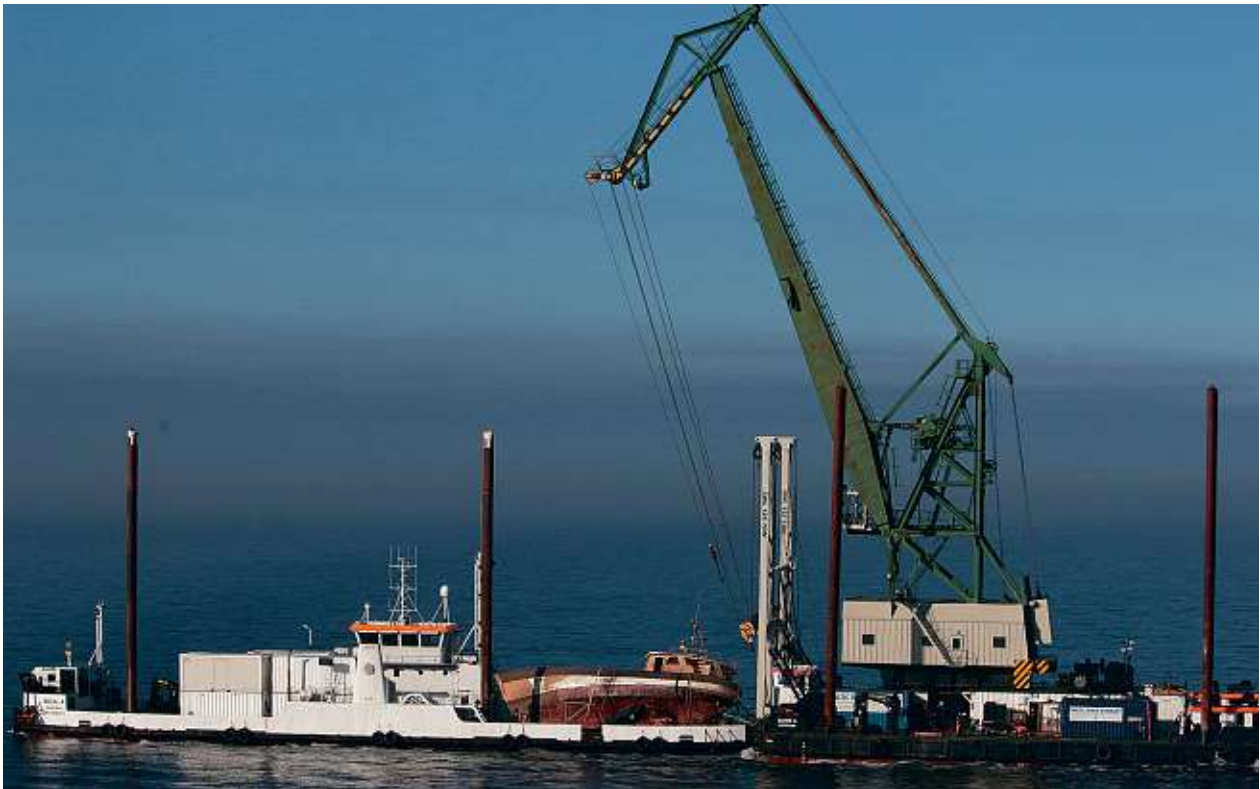
Schwimmkran und Transportschiff mit dem Wrack
