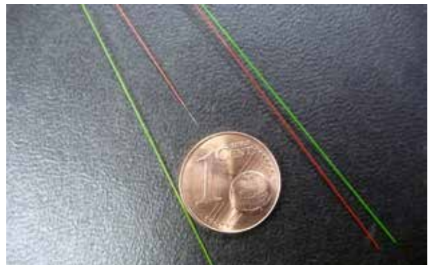
Die weiße Spitze der roten Ader ist die Glasfaser
