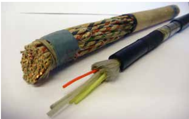
Im Vergleich: Kupferkabel im Hintergrund, LWL-Kabel im Vordergrund
