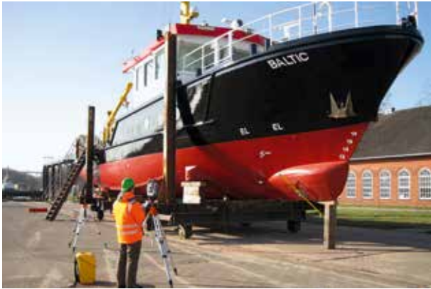
Vermessungstechnische Einmessung des Messsystems
