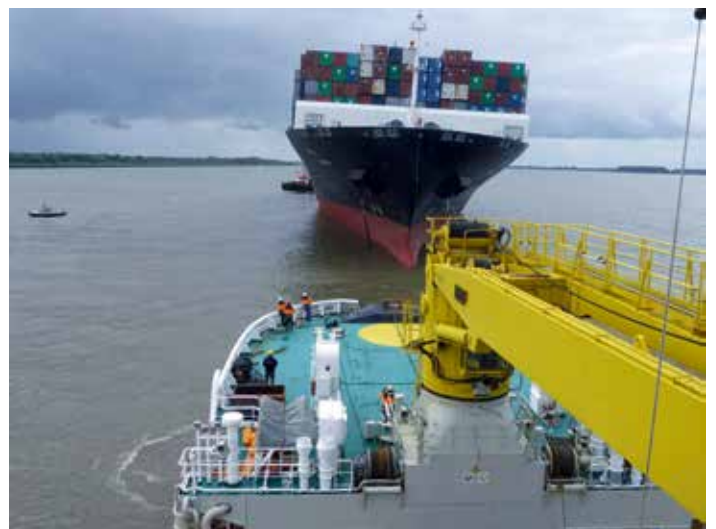
Die Schleppverbindung wird hergestellt.
