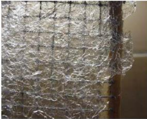
Abbildung 1.2. Glatte kristallines Eis, das im HSVA-Labor erzeugt wurde, Stahlgewebe mit einem Abstand von 0,5 cm[13].
