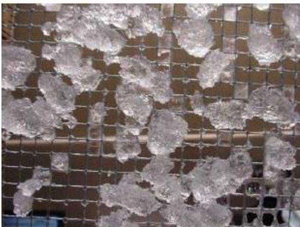
Abbildung 1.6. Eis (aktuelles Eis), erstellt im HSVA-Labor, Stahlgewebe mit einem Abstand von 0,5 cm[13].
