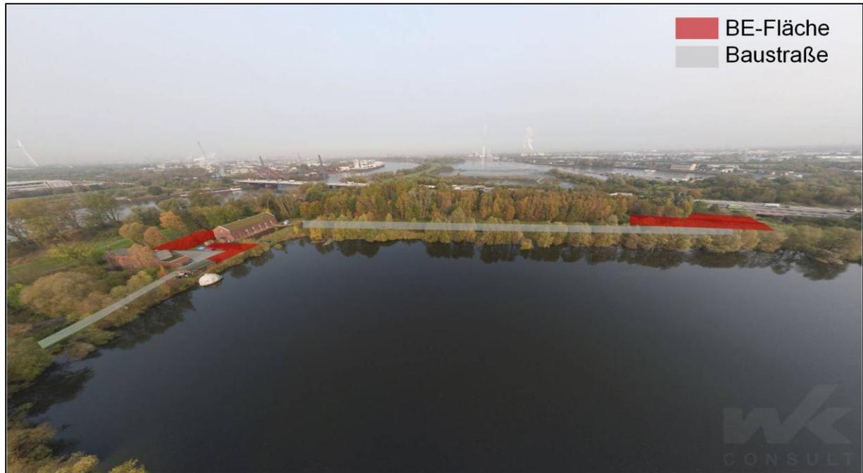
**Abb. 3.2: Drohnenaufnahme Becken D und Gebäude mit schematischen BE-Flächen und Baustraßen**
