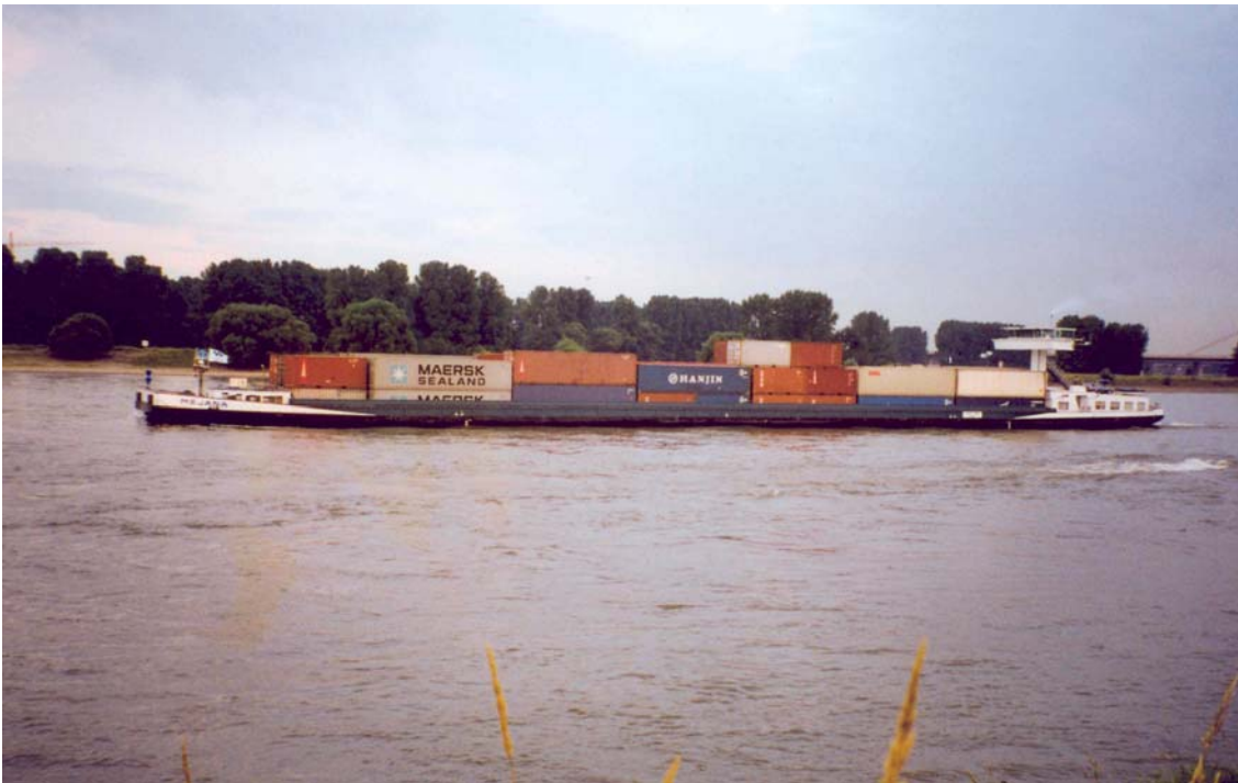
Abb. 8 Container-GMS-110 m auf dem Rhein, Fahrt zu Tal [Foto VBD]
