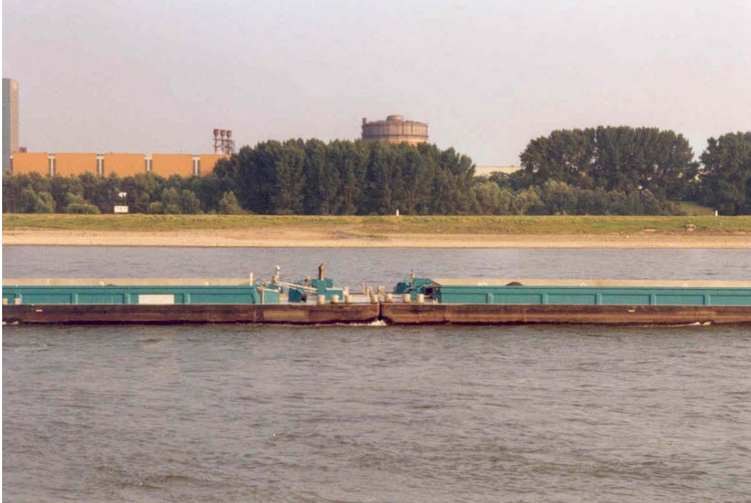
Abb. 12 Koppelverband mit „stumpfer“ Verbindung [Foto VBD]
