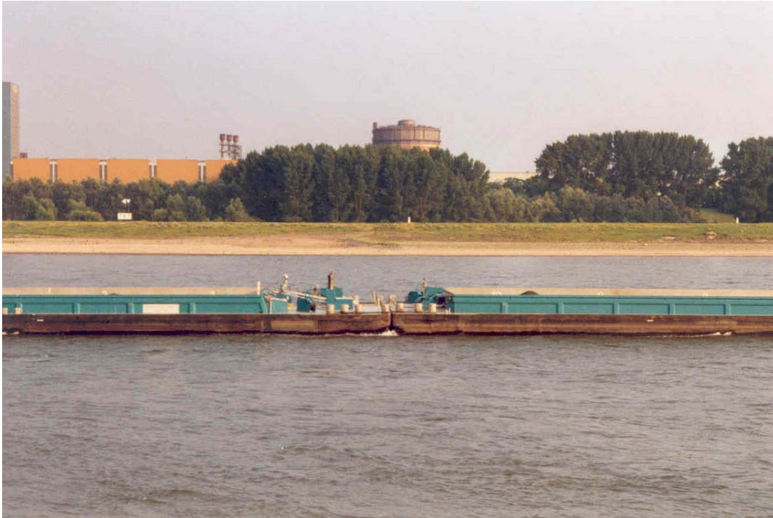
Abb. 12 Koppelverband mit „stumpfer“ Verbindung [Foto VBD]
