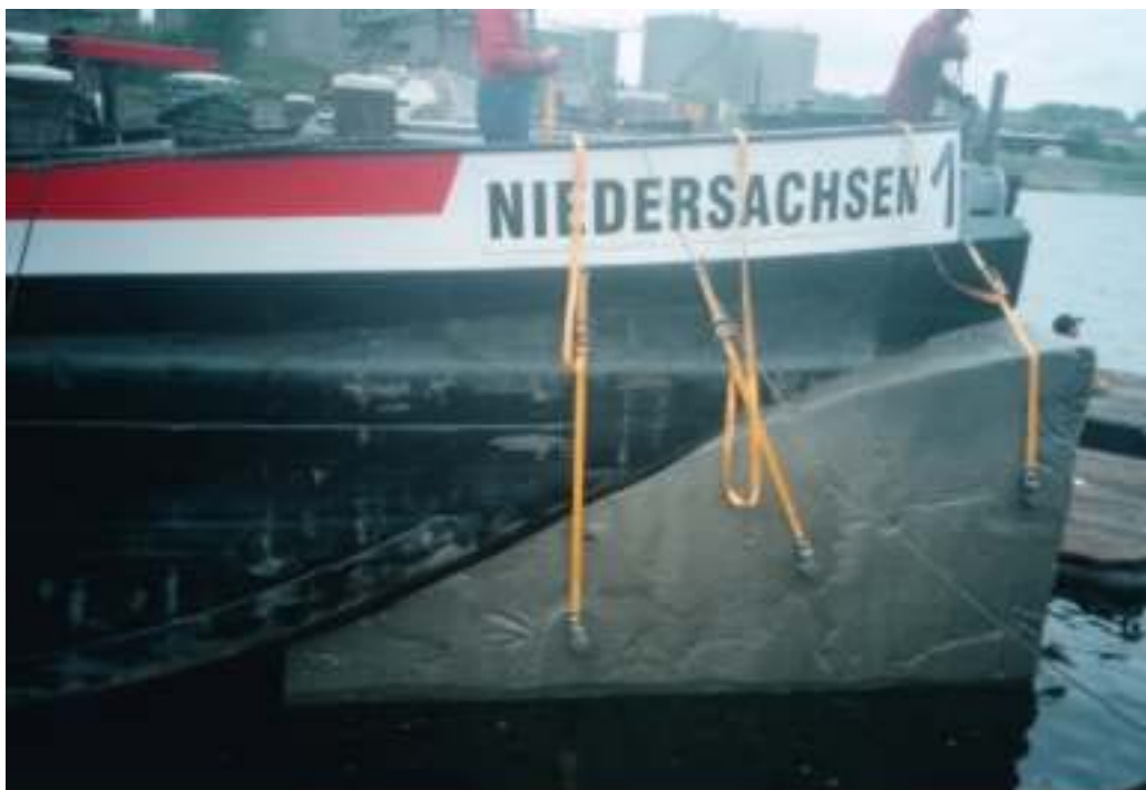
Abb. 14 Großversuch mit Hartschaumkeil im Vorschiffsbereich [Foto VBD]
