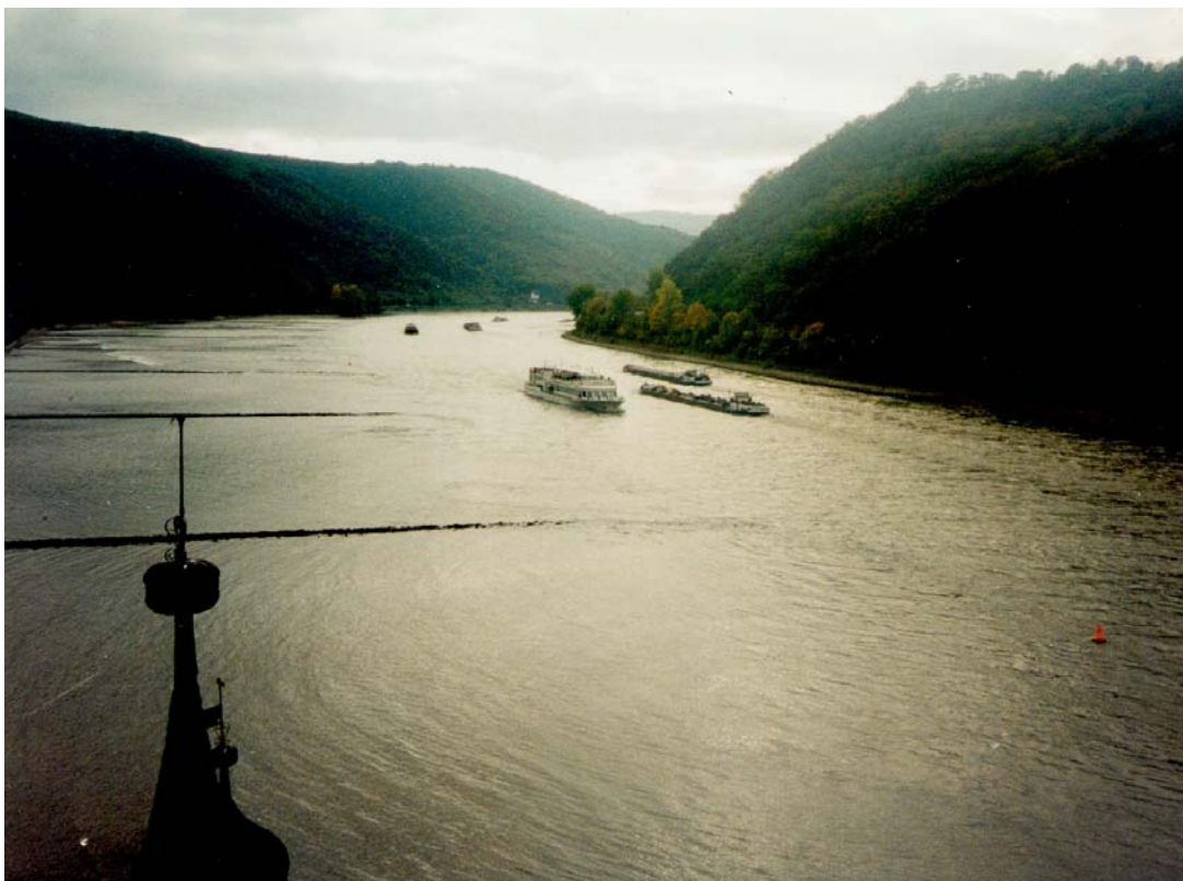
Abb. 2 Begegnungs- und Überholvorgang im Bereich Kaub (Rhein-km 545,6) bergwärts am 25.10.97, Pegel Kaub 1,23 m (Fahrwassertiefe: 2,28 m), [Foto VBD]
