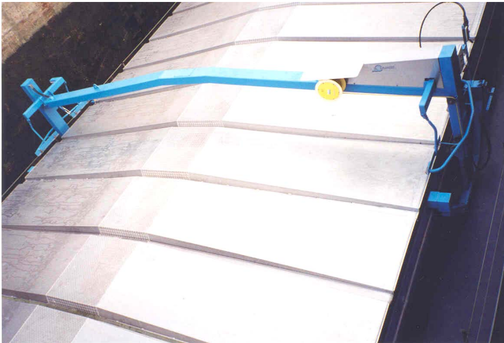
Abb. 15 Alu-Lukendach und Lukentransportwagen auf einem Binnenschiff [Foto VBD]
